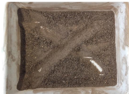
Figure 3 : Méthode de prélèvement d'un échantillon représentatif de terre fine après tamisage à 2 mm.
