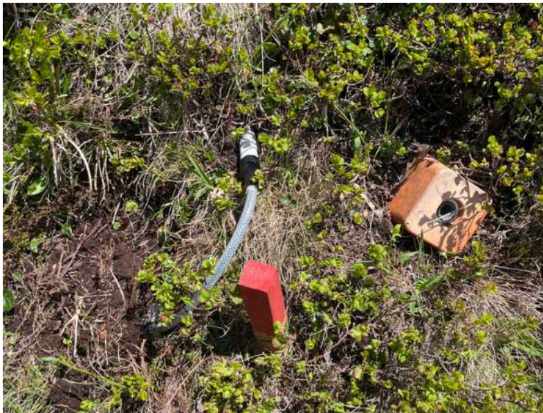
Photo typique du piquet rouge, du flexible TOMST qui sort de la boîte de dérivation, enterrée.
