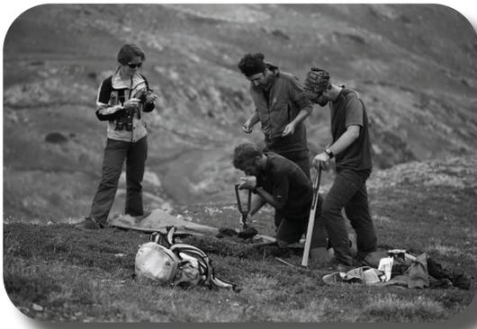
Figure 12: Réalisation d'une fosse pédologique. (source: EDYTEM)
